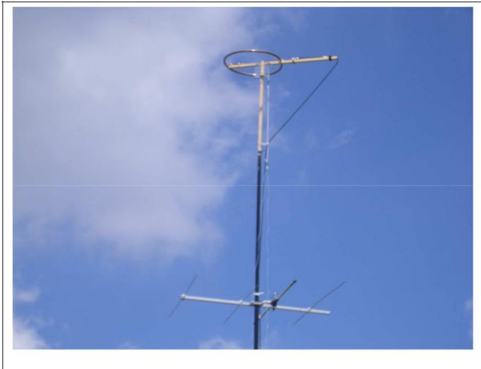
Infatti l’antenna che uso in SOTA è tarata sulla frequenza di 50.180MHz senza nessun “marchingegno” per la sintonizzazione che la appesantirebbe e che forse comprometterebbe anche un po’ le sue caratteristiche radioelettriche.
